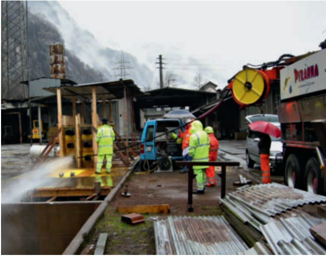
► Bild 10 Baustellenversuchsstand zum Nachweis des Verhaltens von HDPE-Entwässerungsrohren beim Einsatz verschiedener Reinigungstechniken
