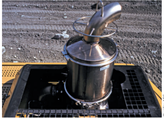
► Bild 4 Beim Bau des Gotthard-Basistunnels galt seit Mitte 2000 die Partikelfilterpflicht
