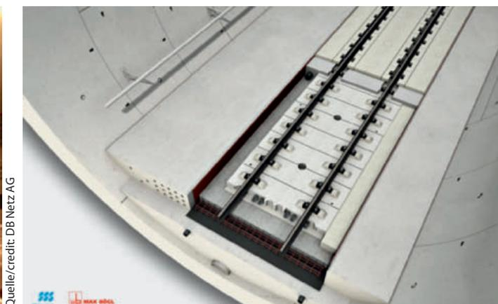
5 Der Katzenbergtunnel, seit 2012 in Betrieb (links), mit einer für Strassenfahrzeuge befahrbaren Sohle, «System Bögl» (rechts)
