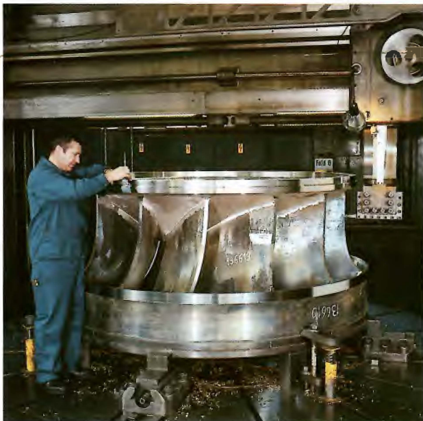
Bild 6.7. Bearbeitung eines Franciscrades im Werk. Der Austrittsdurchmesser des Laufrades beträgt 2,40 \text{ m} , das Gewicht 5,50 \text{ t} . Die Laufräder verarbeiten eine Wassermenge von je 44 \text{ m}^3/\text{s} . (Aufnahme Sulzer-Escher Wyss)
