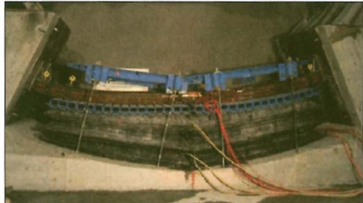
Das Prinzip der Versuche besteht darin, dass der Gebirgsdruck mittels aufpumpbaren Gummikissen simuliert wird. Solche Kissen sind aus der Hebetchnik, zum Heben schwerer Lasten bekannt.
