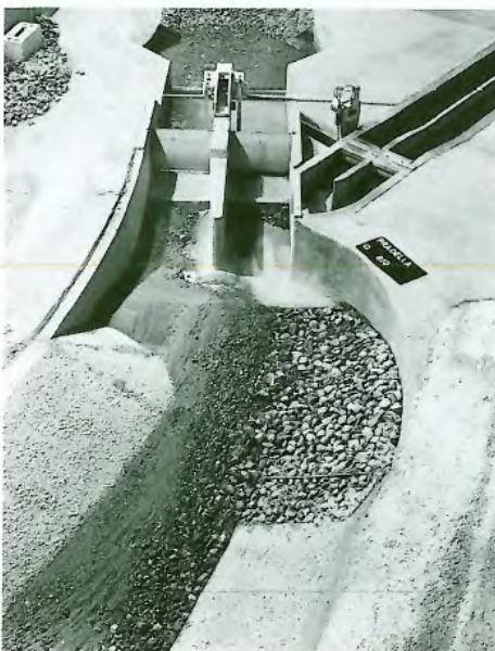
Bild 3.5, links. Hydraulisches Modell der Wehranlage und Innfassung. Zustand des Blockwurfes im Anschluss an ein 100jähriges Hochwasser mit beiden Schützen geöffnet, Blick flussaufwärts (Bild VAW, ETH Zürich).
