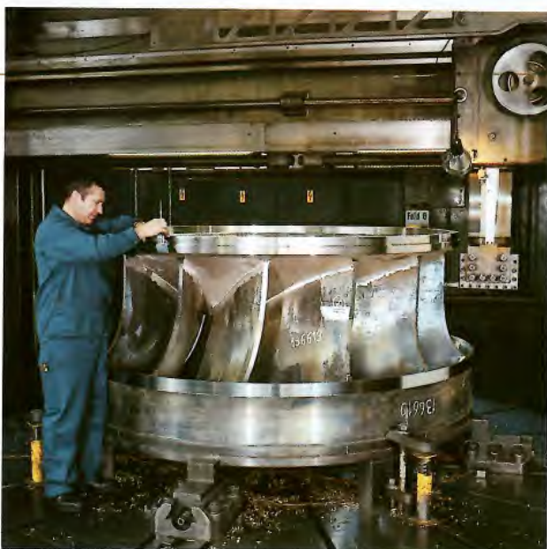
Bild 6.7. Bearbeitung eines Francisrades im Werk. Der Austrittsdurchmesser des Laufrades beträgt 2,40 \text{ m} , das Gewicht 5,50 \text{ t} . Die Laufräder verarbeiten eine Wassermenge von je 44 \text{ m}^3/\text{s} . (Aufnahme Sulzer-Escher Wyss)
